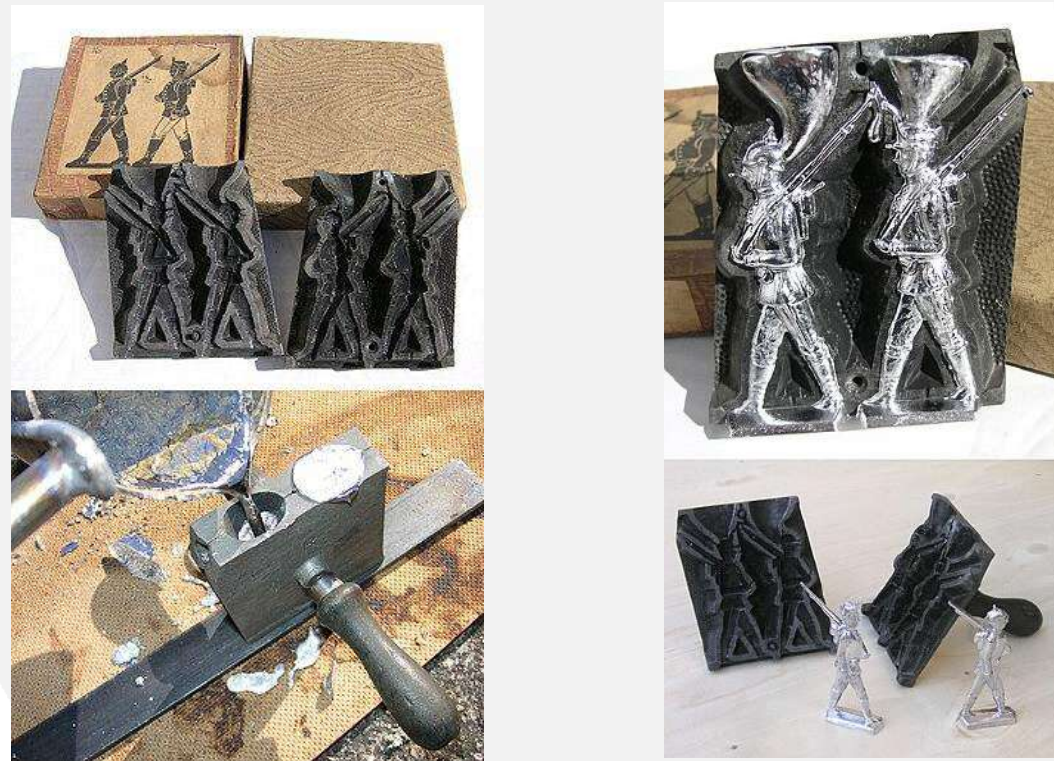
Proces odlewania ołowianej figurki żołnierzyka, fot. wikipedia
